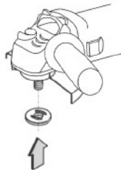
Figura 4 – Montagem de acessório na máquina
